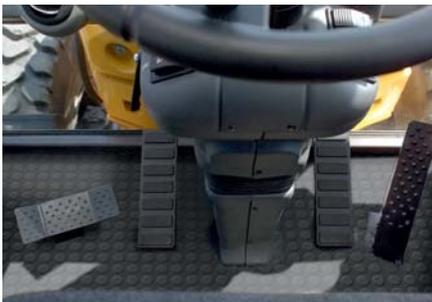
Schwenken mittels Fußpedal für ermüdungsfreies Arbeiten
