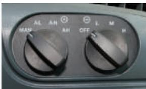
Bei den Radladern der Serie 9A kann der Fahrer die Motorleistung der Maschine sowie das Schaltverhalten des Automatikgetriebes und der Kupplung der Anwendung und seinen Wünschen anpassen. Diese Anpassungsmöglichkeiten der Serie 9A sorgen für höhere Produktivität, mehr Komfort für den Bediener und einen geringeren Kraftstoffverbrauch.
