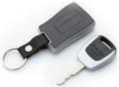
Durch HF-Frequenzidentifizierung erkennt das System, ob der programmierte Smartkey in der Kabine vorhanden ist; dann kann der Bediener den Motor mit der Start/Stopp-Taste starten, ohne dass er einen Zündschlüssel einführen muss. Es können mehrere Smartkeys für die gleiche Maschine programmiert werden, und mehrere Maschinen für den gleichen Smartkey.
