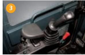
3 Die einstellbaren Armgelenkstützen erhöhen den Komfort.
