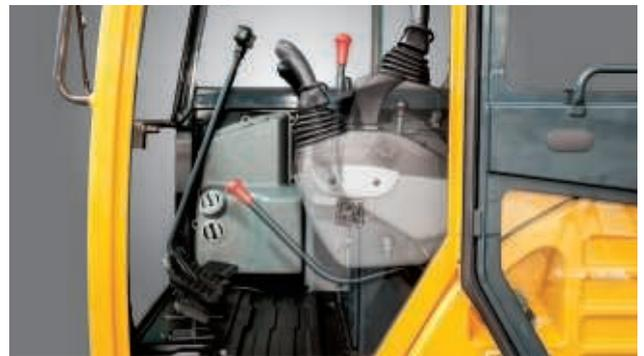
Zugleich erleichtert die aufstellbare Konsole den Zugang zur Kabine. Das Sicherheitsabsperssystem verhindert, dass die Kabine verlassen werden kann, solange der R18-9 in Betrieb ist. Beim Aufstellen des Sicherheitshebels und der linken Konsole werden die Hydraulikfunktionen abgeschaltet.
