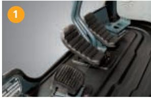
1 Fußstütze, Anbaugerätepedal, linkes und rechtes Fahrpedal und Ausleger-schwenkpedal sind für den Fahrer bequem angeordnet.
