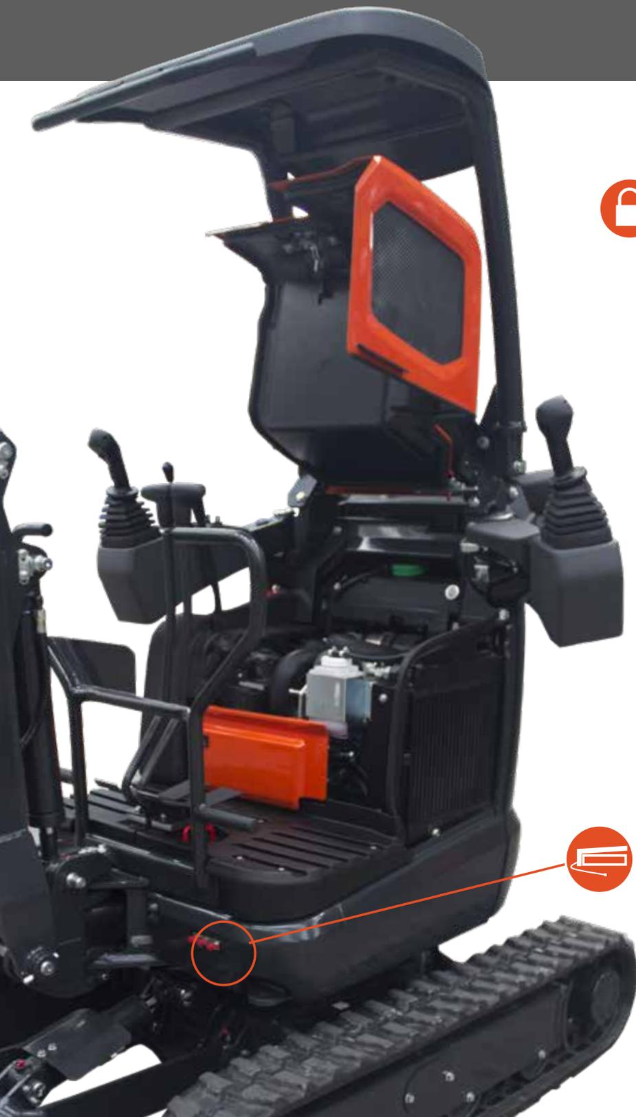
Das praktische und schnelle Einklappen der Sitzgruppe ermöglicht innerhalb weniger Sekunden den Zugriff auf die Services. Zudem kann die Wartung dank der mechanischen Blockierung in vollständiger Sicherheit vorgenommen werden.
