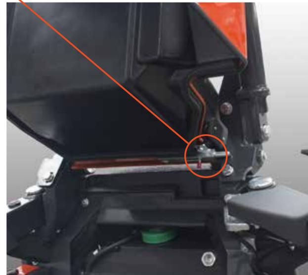
Der seitliche Griff garantiert das besonders einfache Anheben und Schließen von Motorhaube und Sitz.
