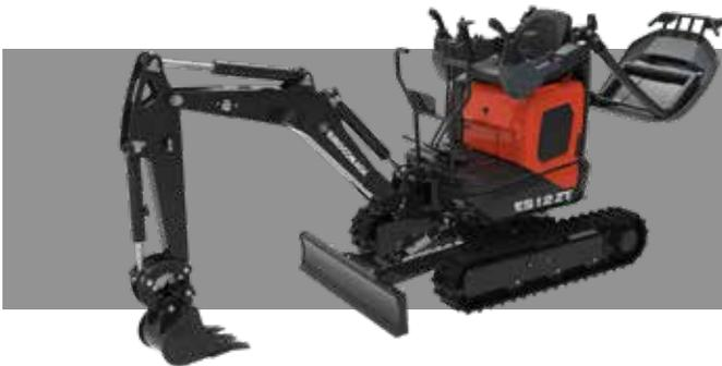
Durch das Entfernen von zwei Schrauben kann der Roll-Bar nach hinten geklappt werden, um die Maschine auch in Räumen mit geringer Höhe zu nutzen. Beide Modelle verfügen über einen Roll-Bar und können zusätzlich mit einem ABS-Dach samt Ablagefach ausgestattet werden.
