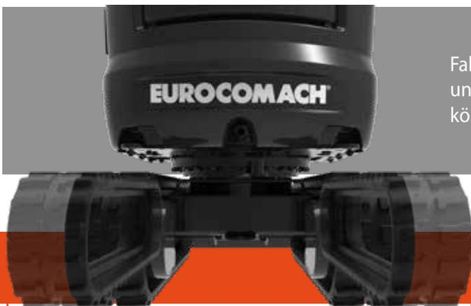
Fahrgestell und Schaufel verfügen über sehr geringe Abmessungen und dank des von 790 auf 1.050 mm verbreiterbaren Fahrgestells können diese Maschinen auch besonders enge Stellen überqueren.
