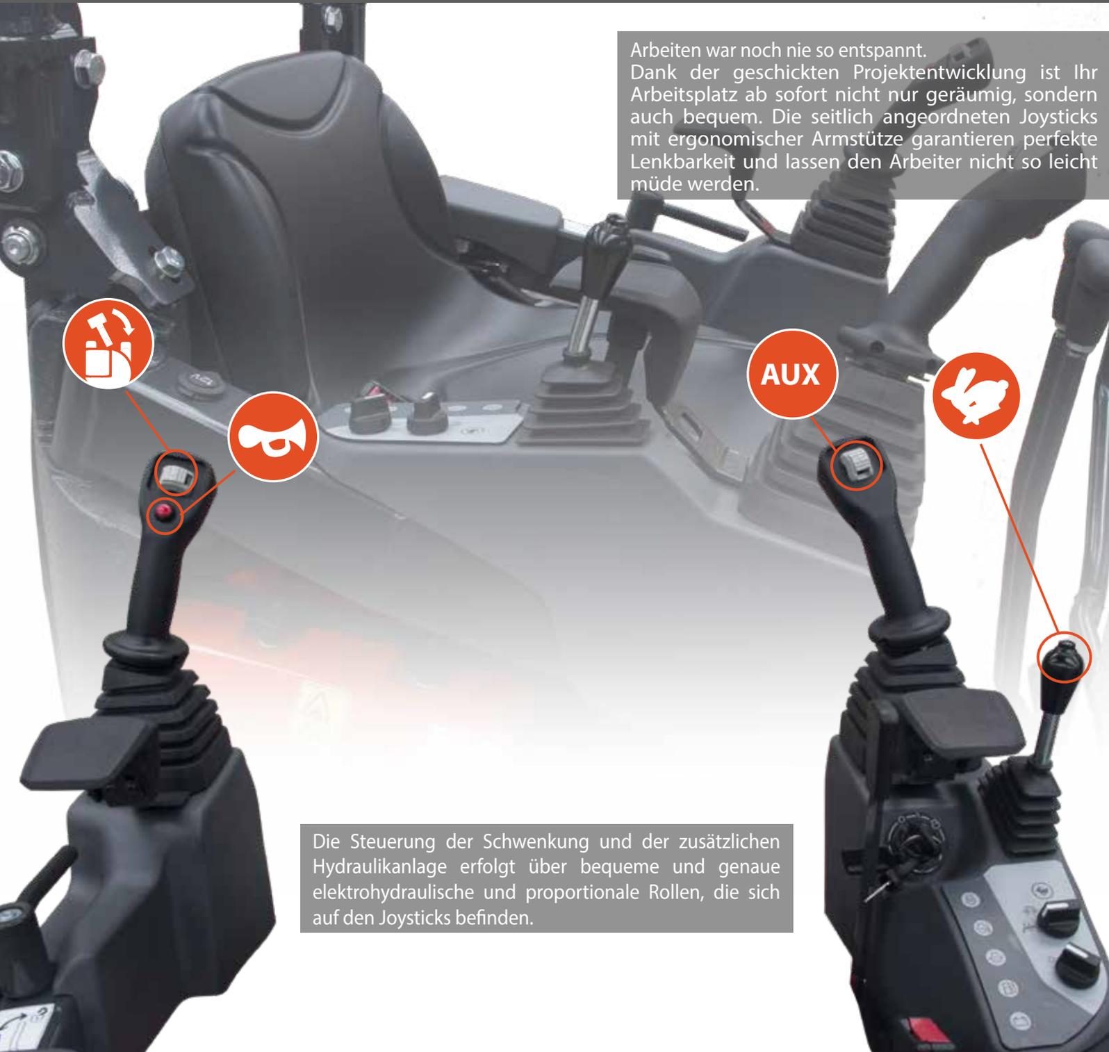
Die Steuerung der Schwenkung und der zusätzlichen Hydraulikanlage erfolgt über bequeme und genaue elektrohydraulische und proportionale Rollen, die sich auf den Joysticks befinden.
